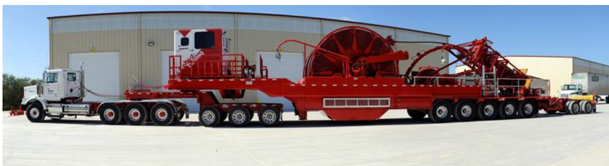
Slika 4-3. Postrojenje za rad sa savitljivim tubingom na prikolici (NOV, 2018c)
