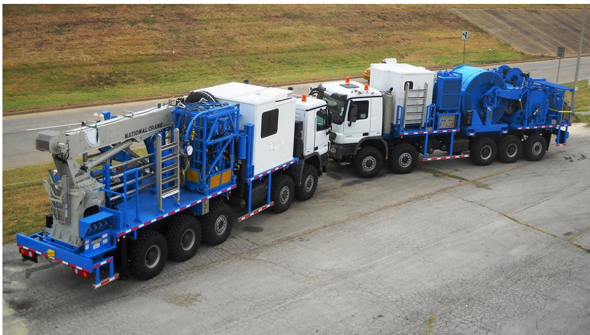
Slika 4-2. Postrojenje za rad sa savitljivim tubingom na kamionu (NOV, 2018b)
