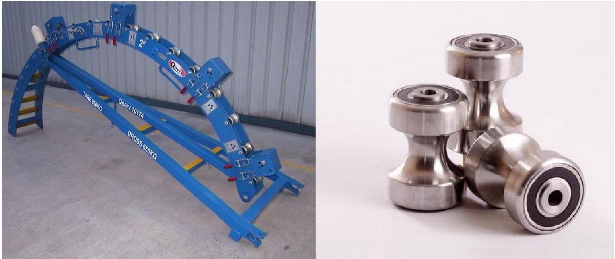
Slika 3-12. Vodicica savitljivog tubinga i pripadajući valjci (Rigarena, 2018)
