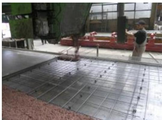
Slika 4-9: Izrada vanjskog sloja eco-sandwich ploče (ECO-SANDWICH, 2015)
