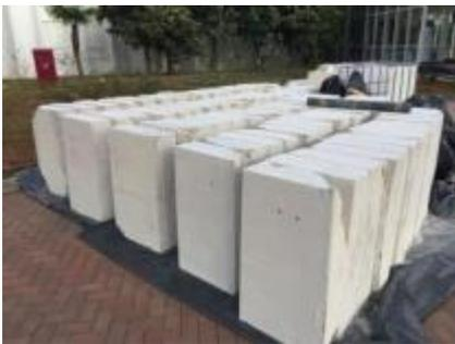
Slika 2-1: betonski blokovi kao građevinski otpad (Dijamantna tehnika Kapusta)
