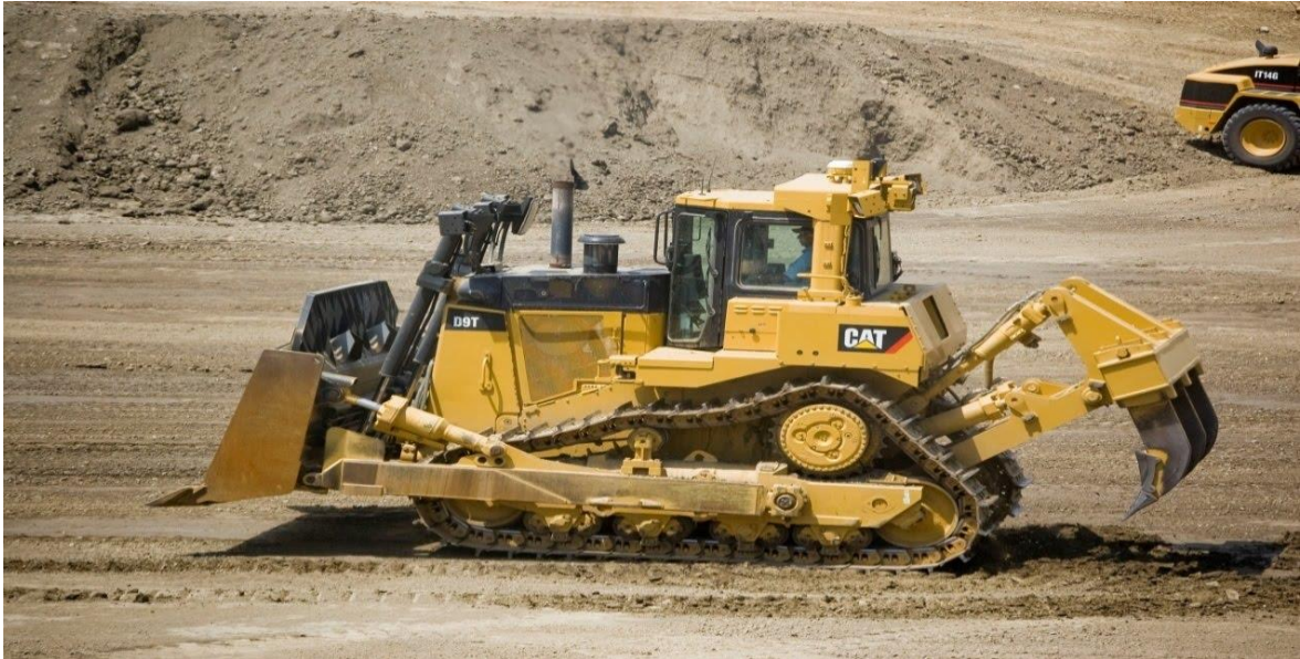
Slika 3-4. Buldozer (Gradbena mehanizacija, 2018)
