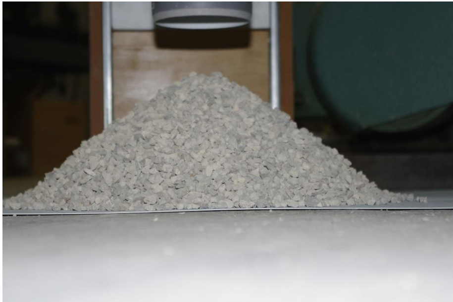
Slika 5-3. Formirana hrpa materijala nakon podizanja cilindra
