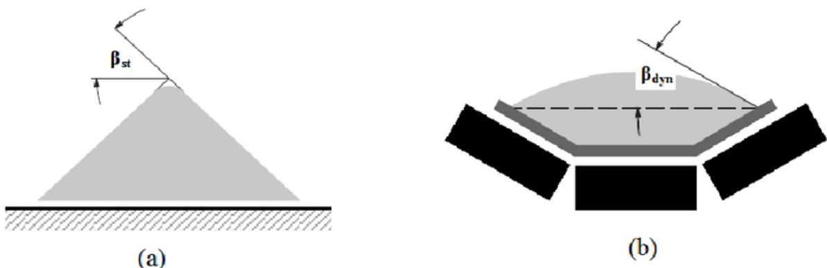
Slika 3-2. a) statički kut sisanja materijala, b) dinamički kut sisanja materijala (Tsakalakis i Micalakopoulos, 2015)
