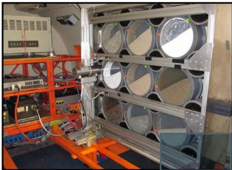
Slika 3-20. Rotirajući cilindri smješteni u avionu za mjerjenje kuta sipanja pri niskoj gravitaciji. (Beakawi i Baghabra, 2018)
