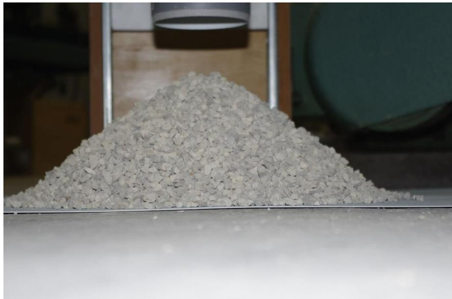
Slika 5-3. Formirana hrpa materijala nakon podizanja cilindra
