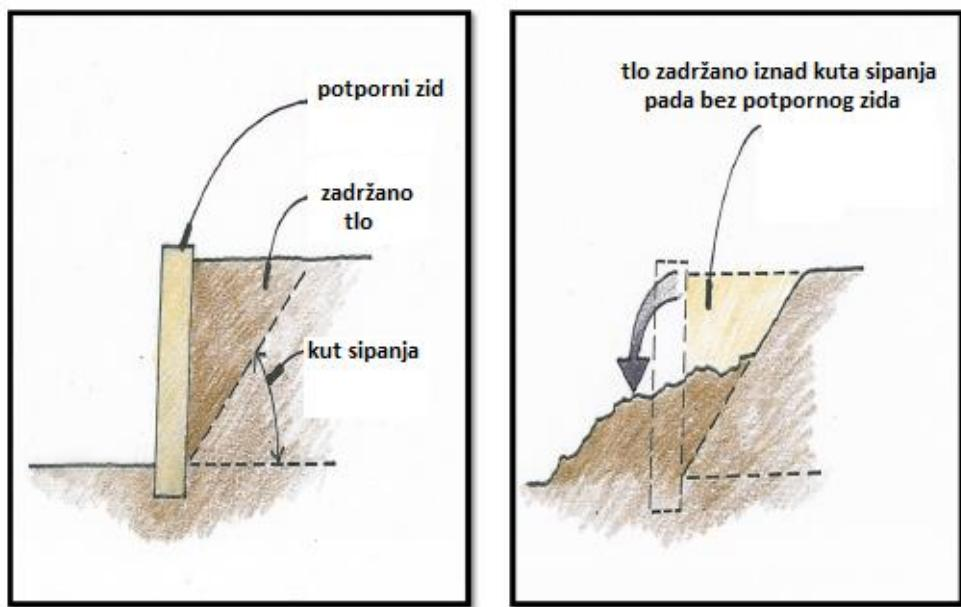
Slika 3-18. Opravdanost potpornog zida koristeći kut sisanja (Beakawi i Baghabra, 2018)
