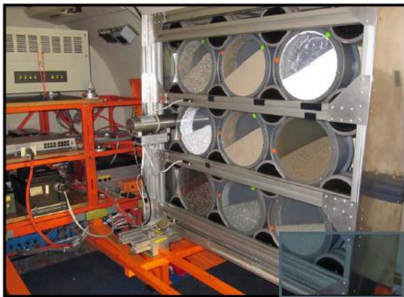
Slika 3-20. Rotirajući cilindri smješteni u avionu za mjerenje kuta sipanja pri niskoj gravitaciji. (Beakawi i Baghabra, 2018)
