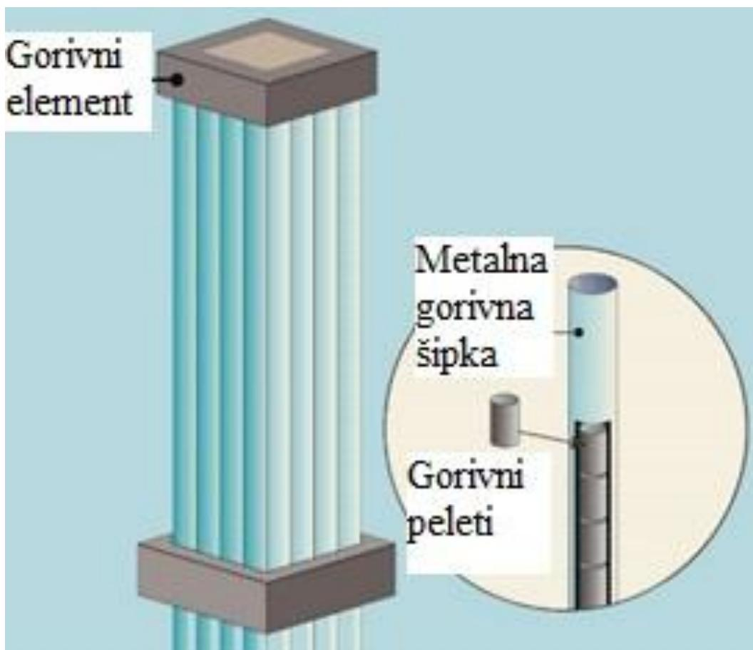
Slika 3-2 Shematski prikaz sadržaja nuklearnog gorivnog elementa
