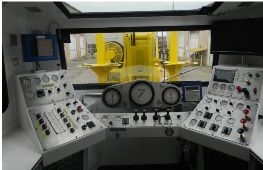
Slika 4-23. Kontrolna kabina postrojenja za rad sa savitljivim tubingom (Consolidated Rig Works, 2018)
