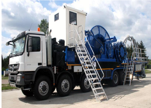
Slika 4-2. Postrojenje za rad sa savitljivim tubingom montirano na teretno vozilo (Goes, 2015b)
