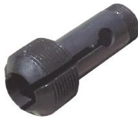
Slika 5-22. Čeljusti za unutarnje hvatanje (National Oilwell Varco, 2016)
