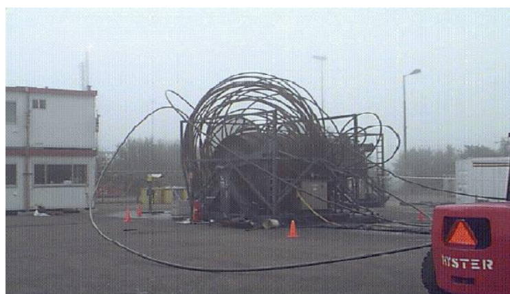
Slika 4-13. Primjer loše manipulacija savitljivim tubingom (CTES, 2005)
