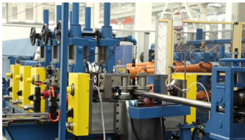
Slika 3-8. Oblikovanje čeličnih traka (Jason Oil & Gas Equipment LLC, 2018)
