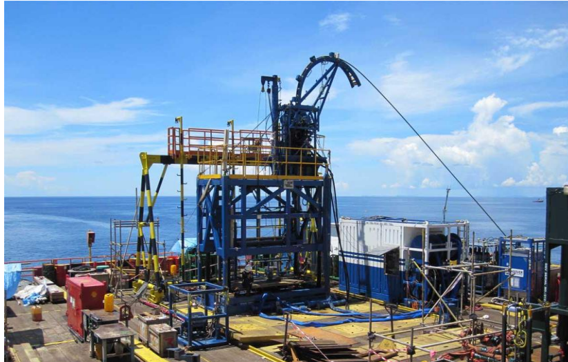
Slika 4-4. Odobalno postrojenje za rad sa savitljivim tubingom (National Oilwell Varco, 2018c)
