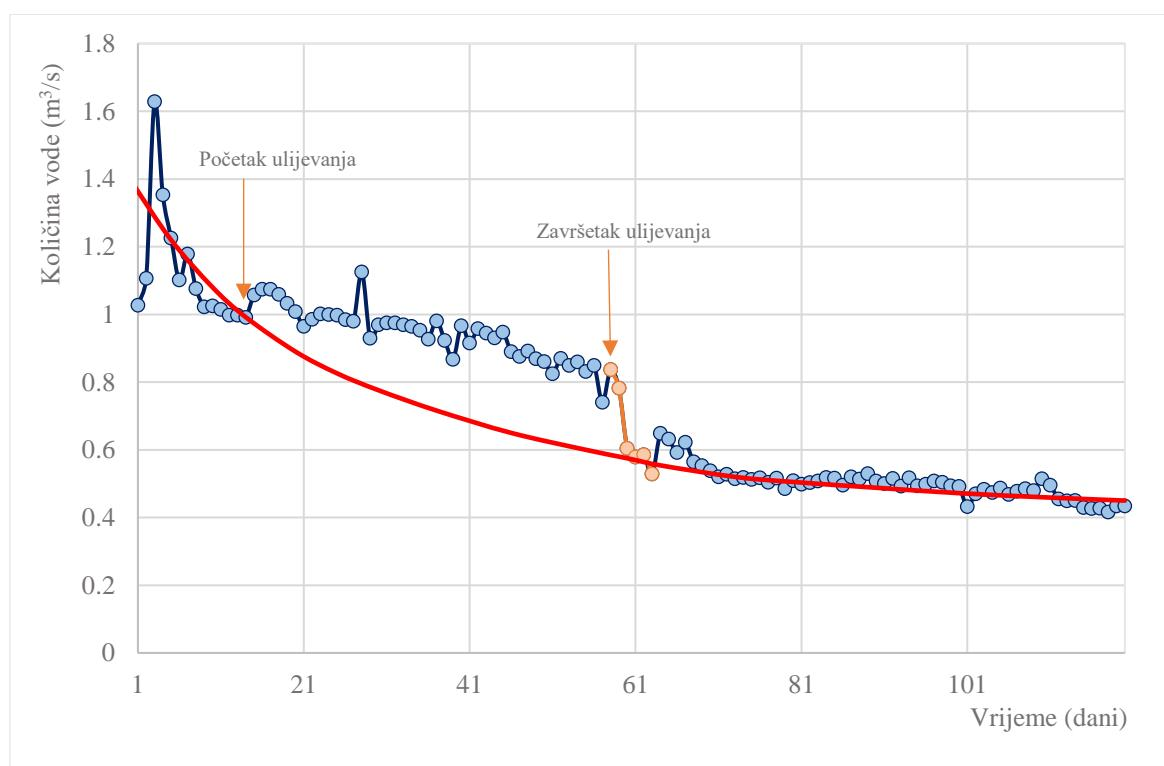
Slika 5.2. Prikaz promjene izdašnosti izvora Gradole u vremenu te aproksimirane glavne recessijske krivulje za promatrano razdoblje.
