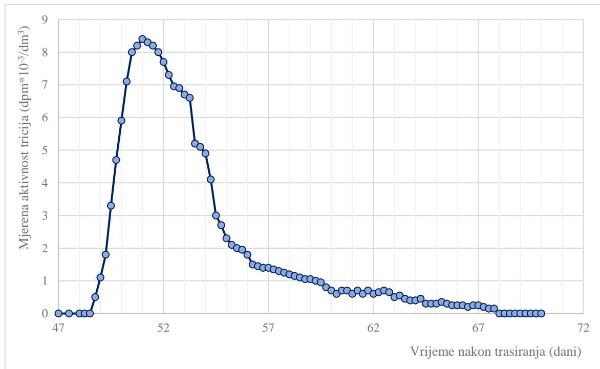
Slika 3.9. Mjerena aktivnost tricija u odnosu na vrijeme proteklo od trasiranja
