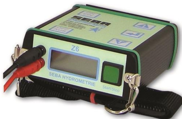
Slika 2-5. Elektronički brojač okretaja propelera
