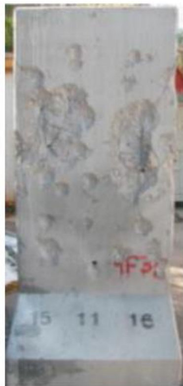
Slika 5-8. Prednje strane betonskih zidova opterećenih eksplozivom sa udaljenosti od 2 i 3 m (Grisaro i dr., 2017)
