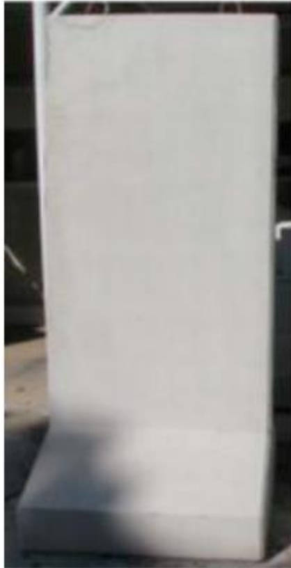
Slika 5-7. Neoštećena betonska ploča (Grisaro i dr., 2017)
