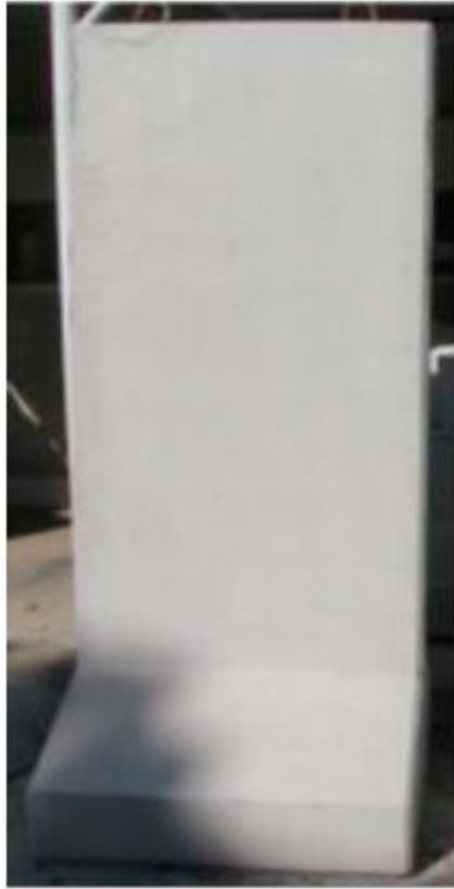
Slika 5-7. Neoštećena betonska ploča (Grisaro i dr., 2017)
