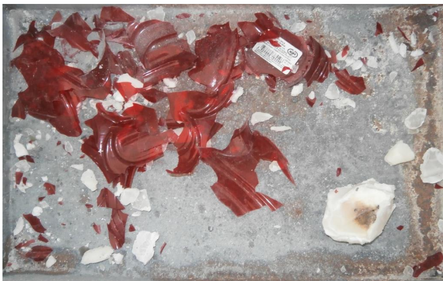
Slika 3-10. Usitnjeni lampioni nakon drobljenja u udarnoj drobilici
