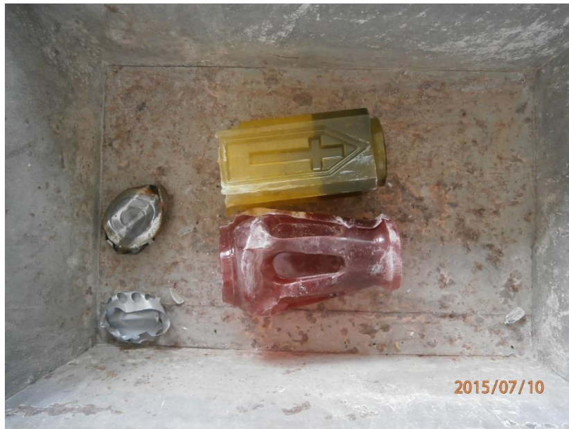
Slika 3-3. Lampioni nakon drobljenja u čeljusnoj drobilici
