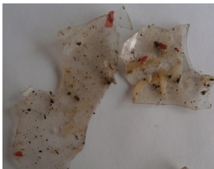
Slika 3-23. Parafin zaostao na plastici
