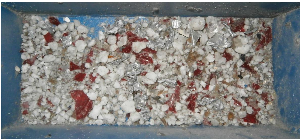
Slika 3-11. Usitnjeni lampioni nakon čekićare
