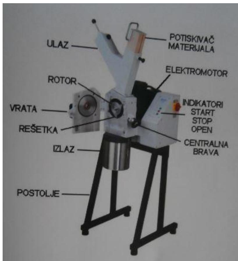
Slika 3-6. Mlin za rezanje Retsch SM 2000
