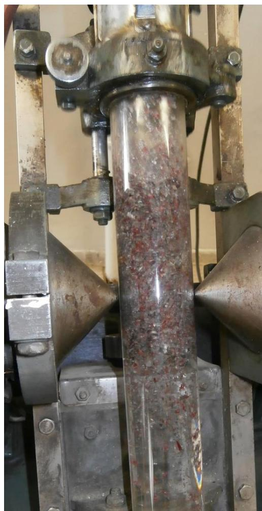
Slika 3-14. Materijal tokom magnetske separacije
