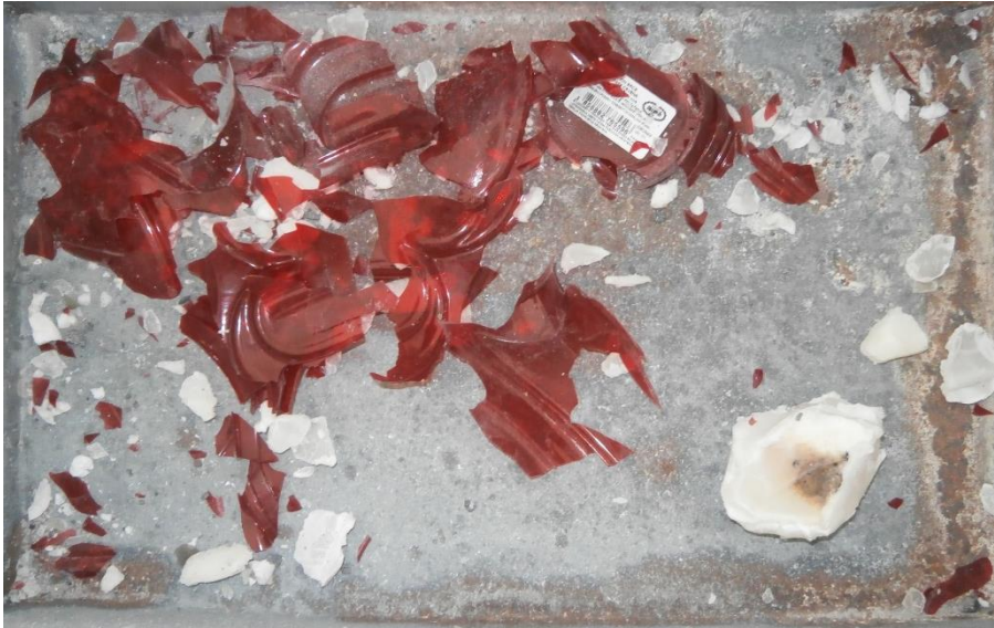
Slika 3-10. Usitnjeni lampioni nakon drobljenja u udarnoj drobilici
