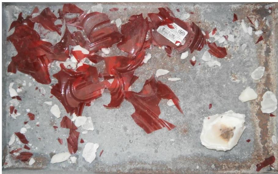
Slika 3-10. Usitnjeni lampioni nakon drobljenja u udarnoj drobilici
