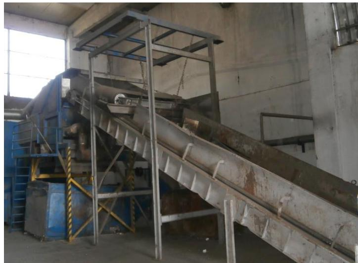
Slika 5-3. Zračni separator s magnetskim separatorom
