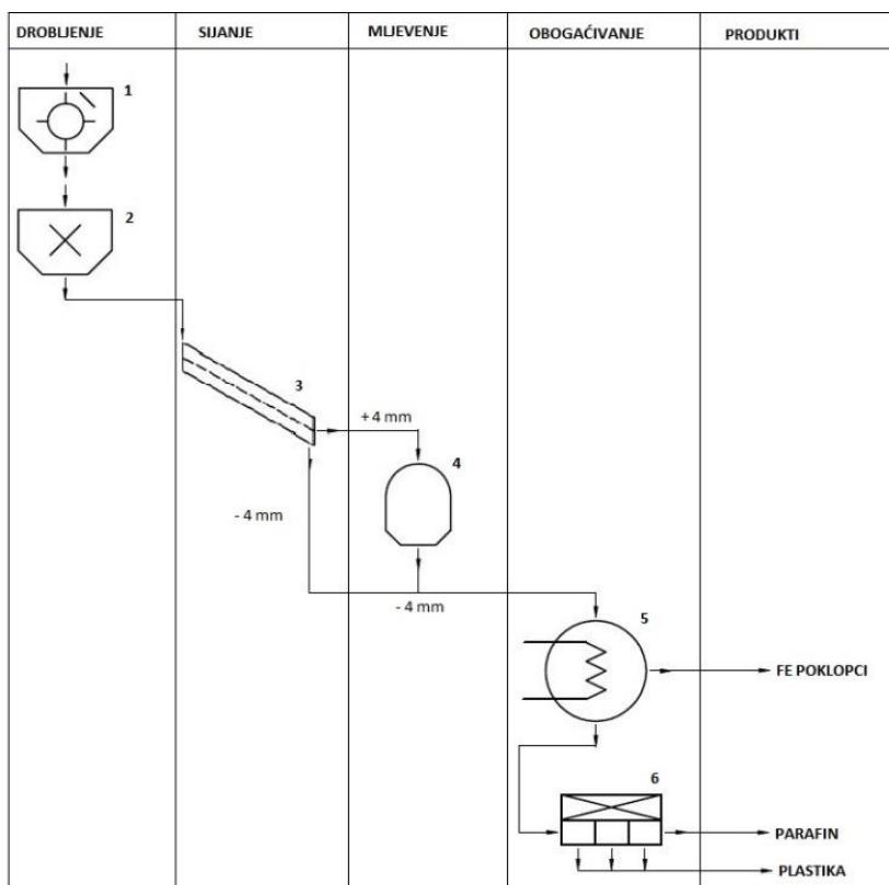
Slika 3-9. „Početna“ segregacijska shema I Udarna drobilica, 2 Čekićara, 3 Sito, 4 Rezni mlin, 5 Niskointenzivni mokri magnetski separator, 6 Plakalica
