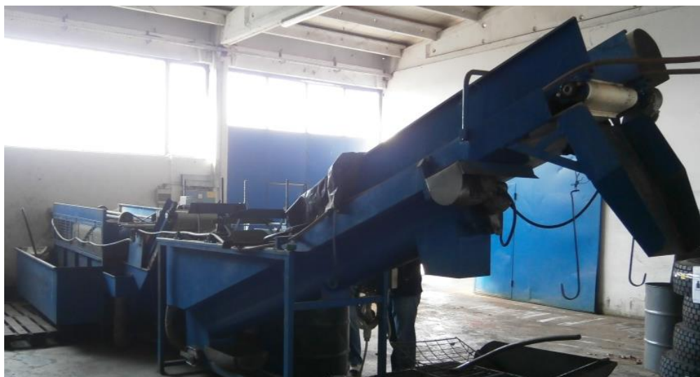
Slika 5-5. Separator za razdvajanje plastike i parafina
