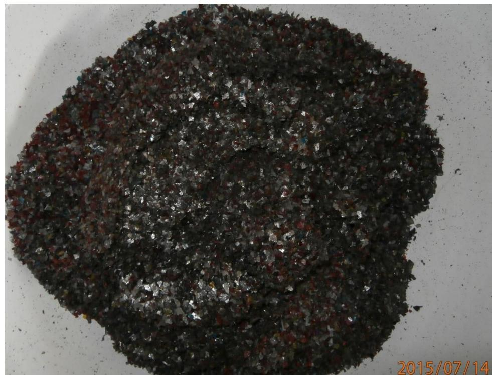
Slika 3-13. Materijal nakon reznog mlina
