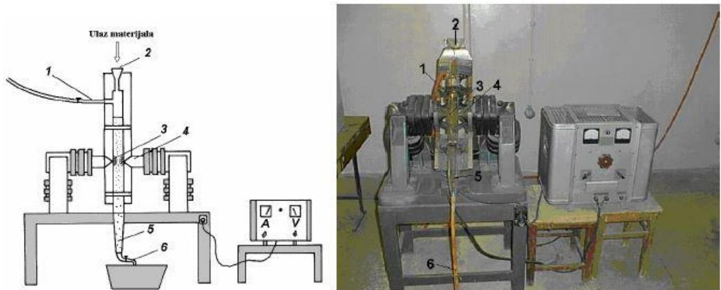
Slika 3-7. Niskointenzivni mokri magnetski separator
