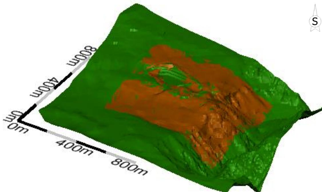
Slika 6-1 Prikaz trianguliranih površina potrebnih za proračun
