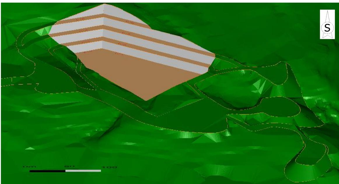
Slika 5-9 3D model tehničke sanacije površinskog kopa boksita
