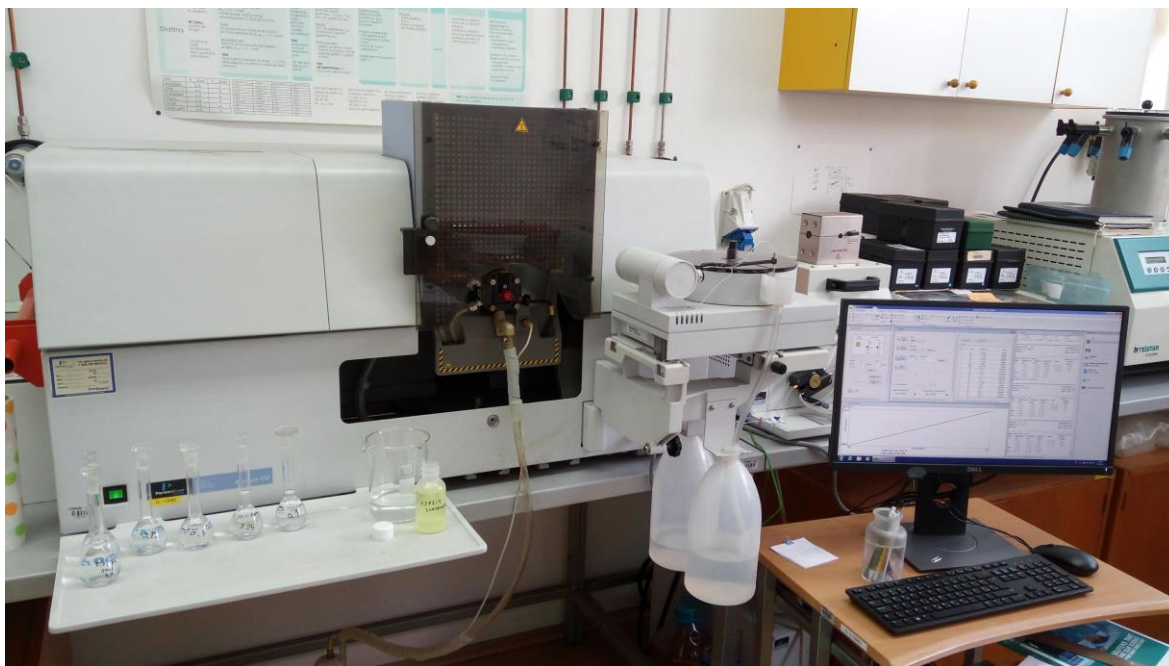
Slika 3.14. Atomski spektrometar PerkinsElmer Analyst 700 (foto: Borna-Ivan Balaž, 2018)
