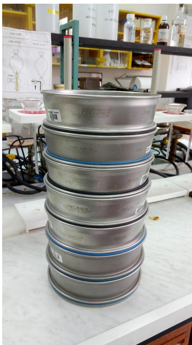
Slika 3.9. Kolona sita složena od najvećeg prema najmanjem promjeru otvora ( foto: Borna-Ivan Balaž, 2018 )
