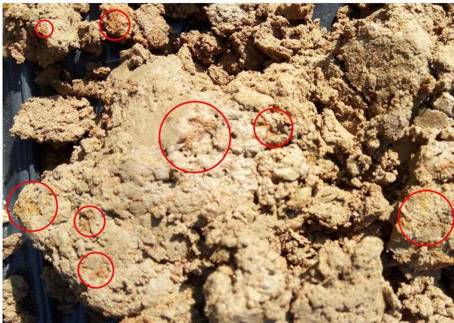
Slika 3.5. Pojava željezovitih prevlaka u uzorcima (foto: Borna-Ivan Balaž, 2018)
