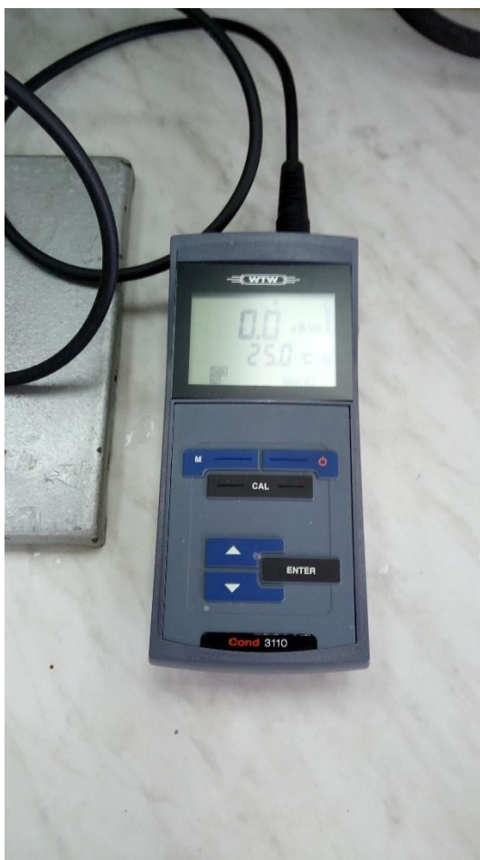
Slika 3.8. Konduktometar WTW Cond 3110 (foto: Borna-Ivan Balaž, 2018)
