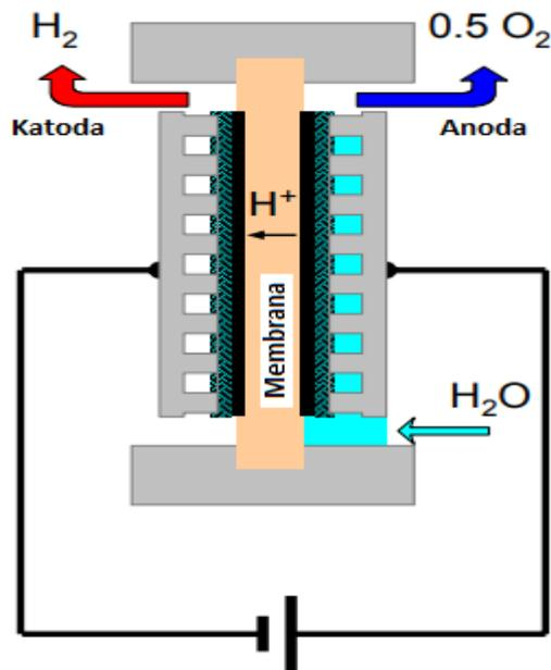
Slika 4-1 Shematski prikaz PEM elektrolize (preuređeno od Smolinka, 2010)
