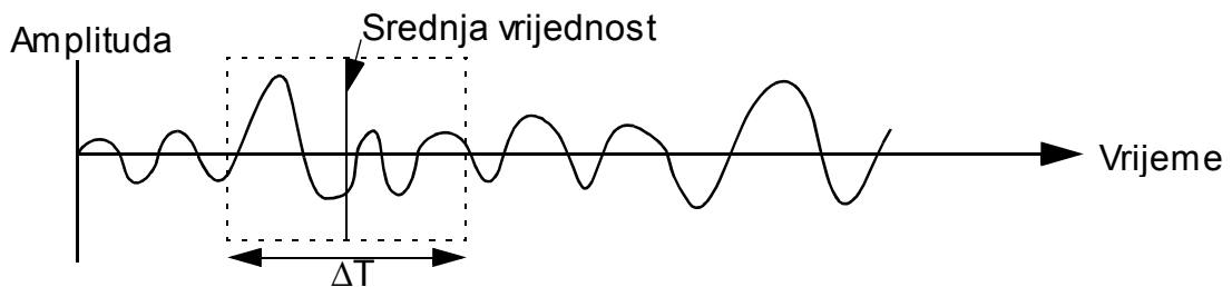
Slika 3-12 Princip AGC pojačanja
