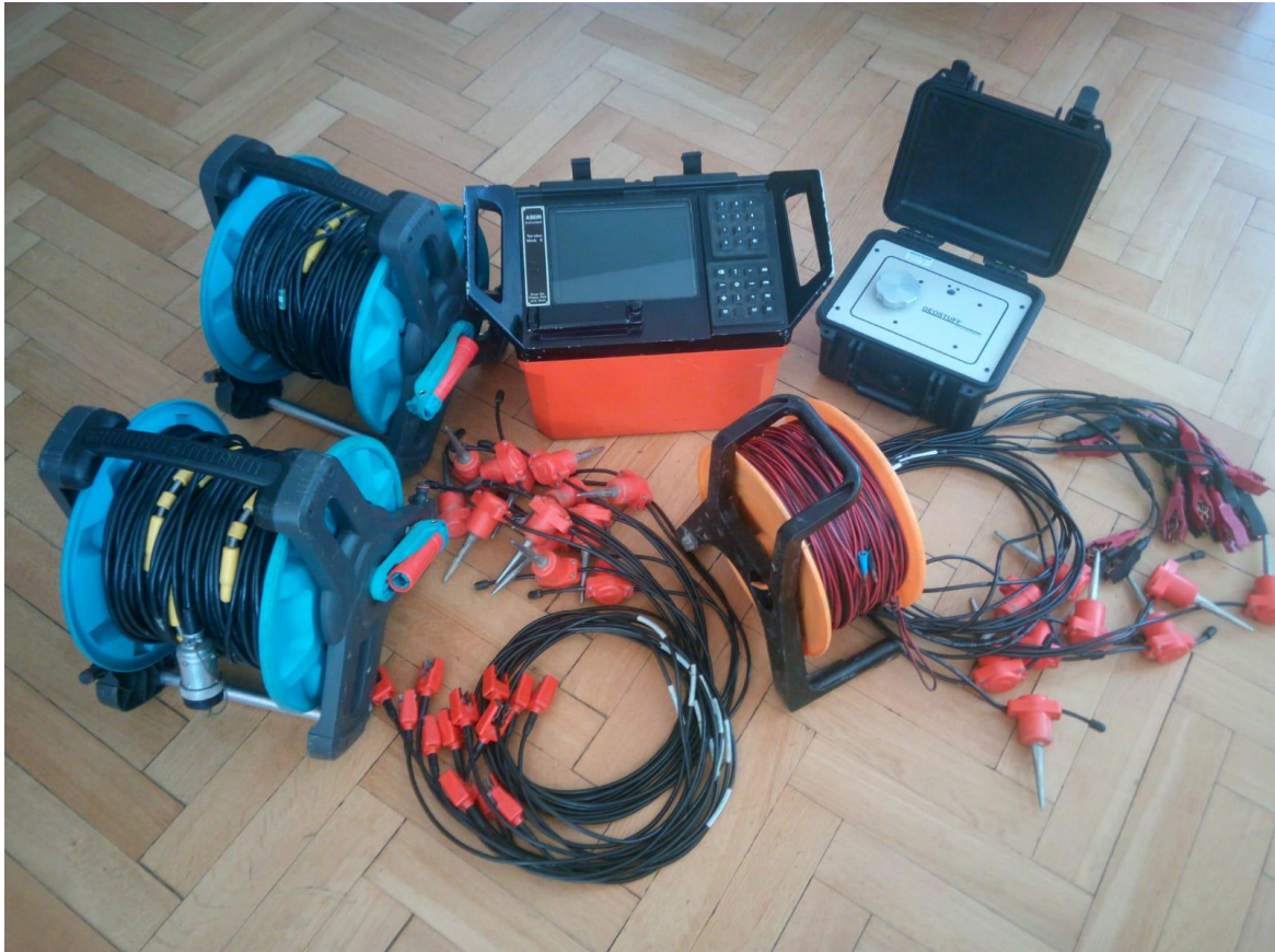
Slika 3-4 Digitalni 24 - kanalni seizmograf Terraloc Mk 6
