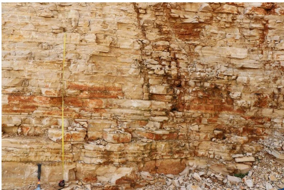
Slika 6.11. Otkopna fronta na kojoj su obavljena mjerena debljina slojeva i uzorkovanje.
