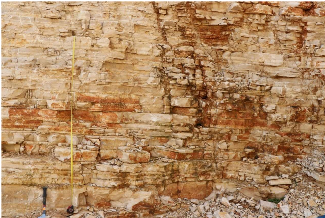
Slika 6.11. Otkopna fronta na kojoj su obavljena mjerenja debljine slojeva i uzorkovanje.
