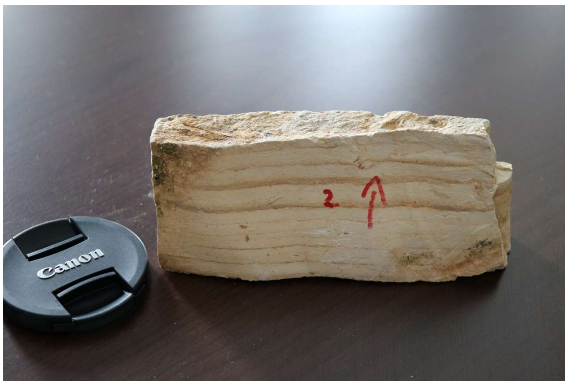
Slika 6.2. Uzorak kamena sa vidljivom laminacijom, izmjena mikritnog i zrnskog vapnenca.
