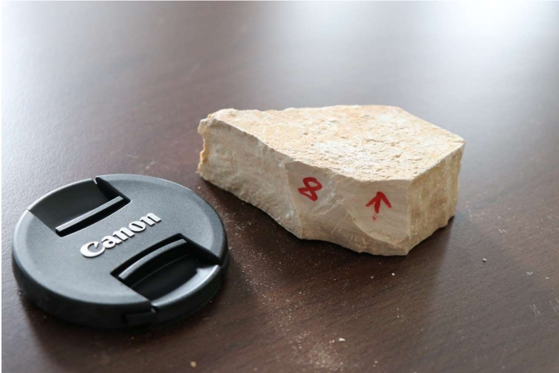
Slika 6.3. Uzorak kamena iz sloja 8 na kojem se vidi školjkasti lom, te boja kamena kakva je uglavnom prisutna u svim slojevima.
