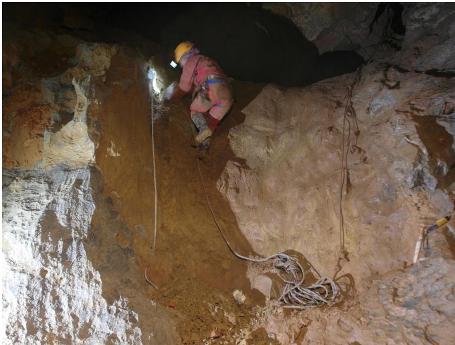
Slika 5-3. Registriranje magnetskog susceptibiliteta na profilu SL1 u Slovačkoj jami (foto: Dalibor Paar).
