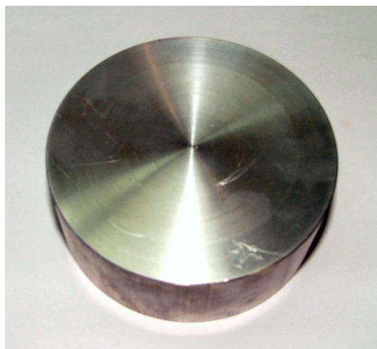
Slika 4-9. Aluminijski cilindar nakon detonacije.
