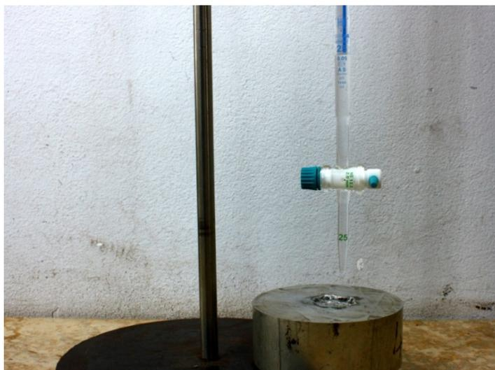
**Slika 4-13.** Mjerenje volumena otiska na aluminijskom cilindru.
