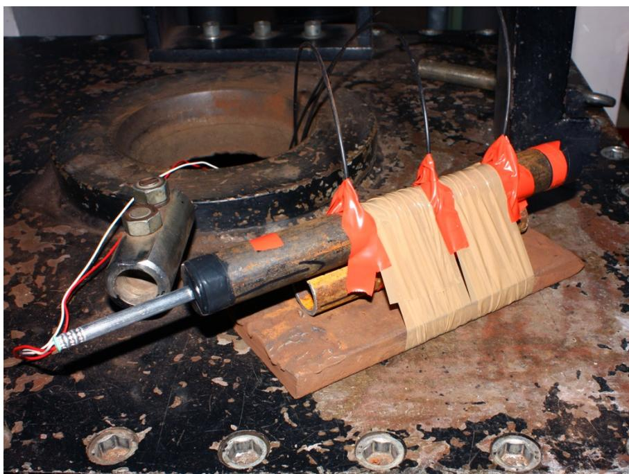
**Slika 4-16.** Fotografija postava mjerenja kod ispitivanja s dvostrukim cijevima.
