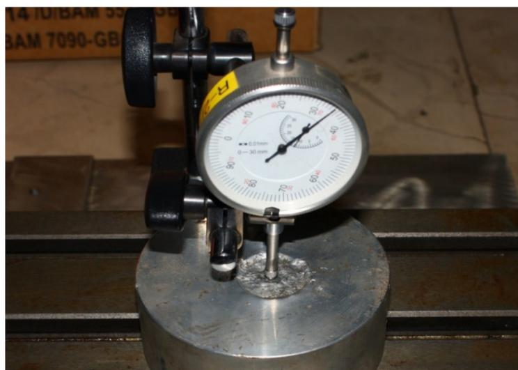
**Slika 4-12** Mjerenje dubine otiska u aluminijskom cilindru mikrourom.
