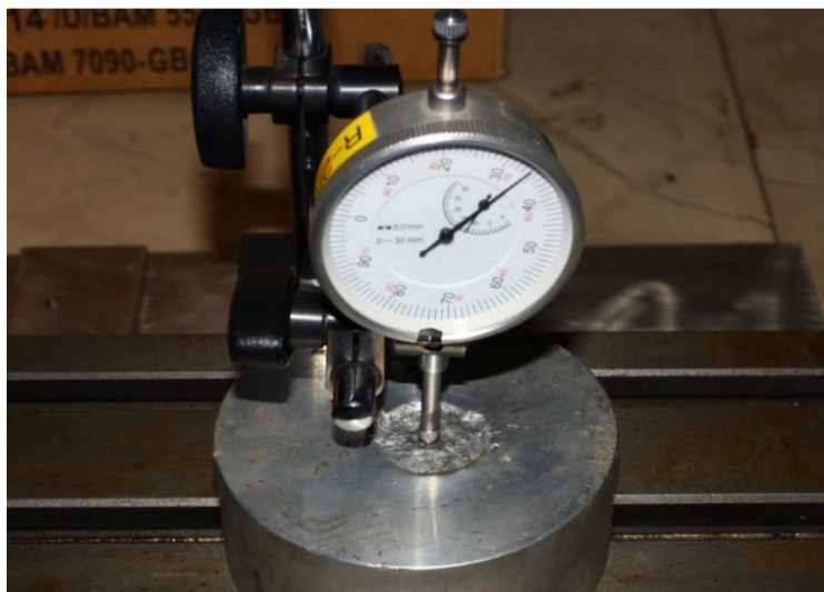
Slika 4-12 Mjerenje dubine otiska u aluminijskom cilindru mikrourom.
