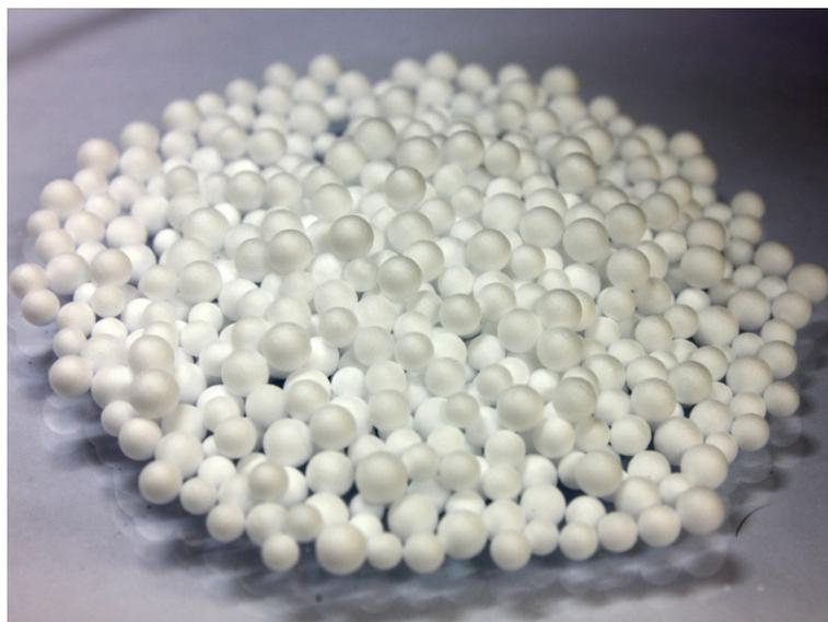
**Slika 3-5.** Granule ekspandiranog polistirena.
