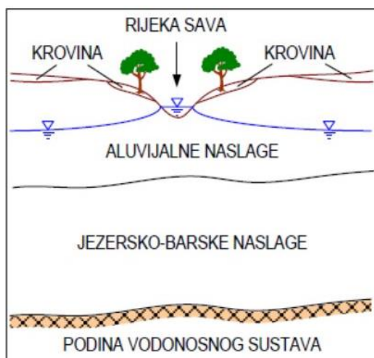
Slika 2.2. Shematski prikaz poprečnog presjeka zagrebačkog vodonosnog sustava (Posavec, 2006)
