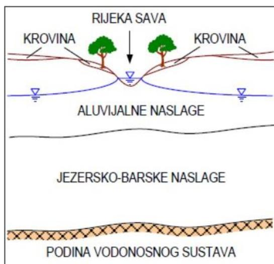
Slika 2.2. Shematski prikaz poprečnog presjeka zagrebačkog vodonosnog sustava
