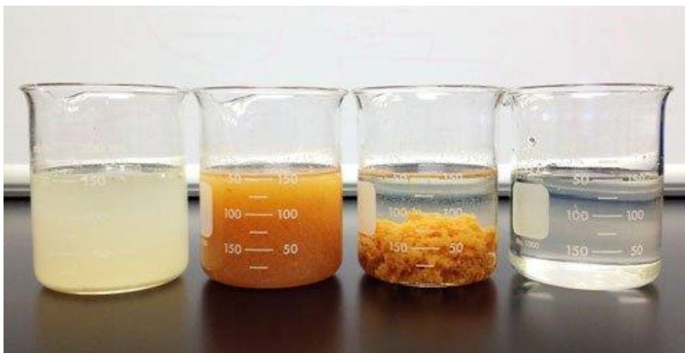
Slika 2-7 Koagulacija/flokulacija (Ecologix environmental system, 2018 )
