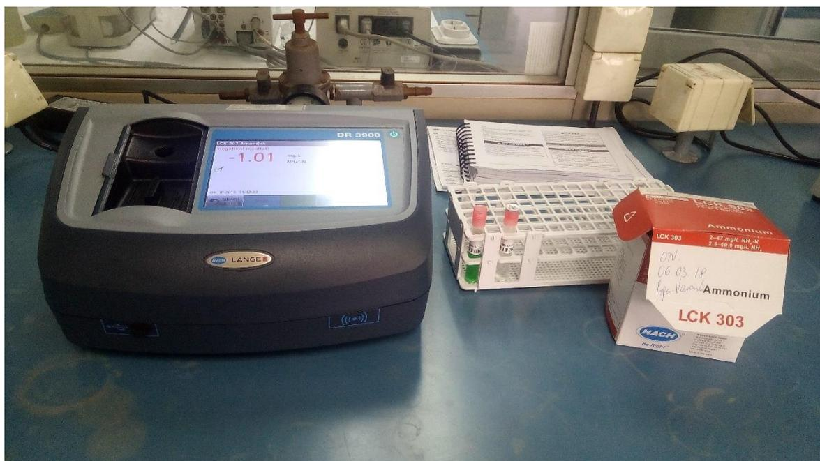
Slika 3-5 Uređaj Spektrofotometar DR 3900
