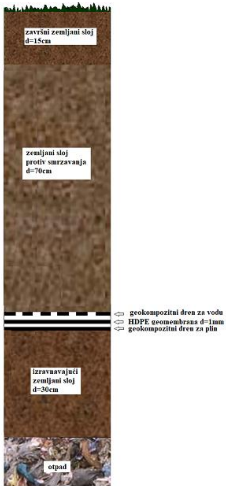
Slika 6. 3. Pokrovni sustav odlagališta otpada Tarno (prema H-PROJEKT 2008).
