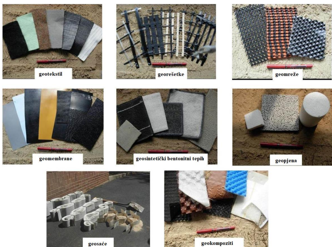
Slika 3. 2 Prikaz osam grupa geosintetičkih materijala (Wikipedija 2014).
