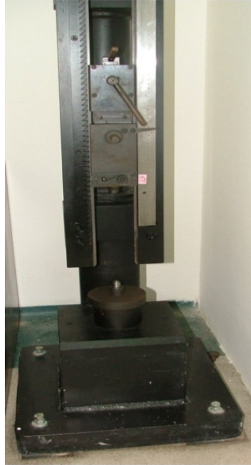
Slika 4.8 BAM uređaj za određivanje osjetljivosti eksploziva na udar
