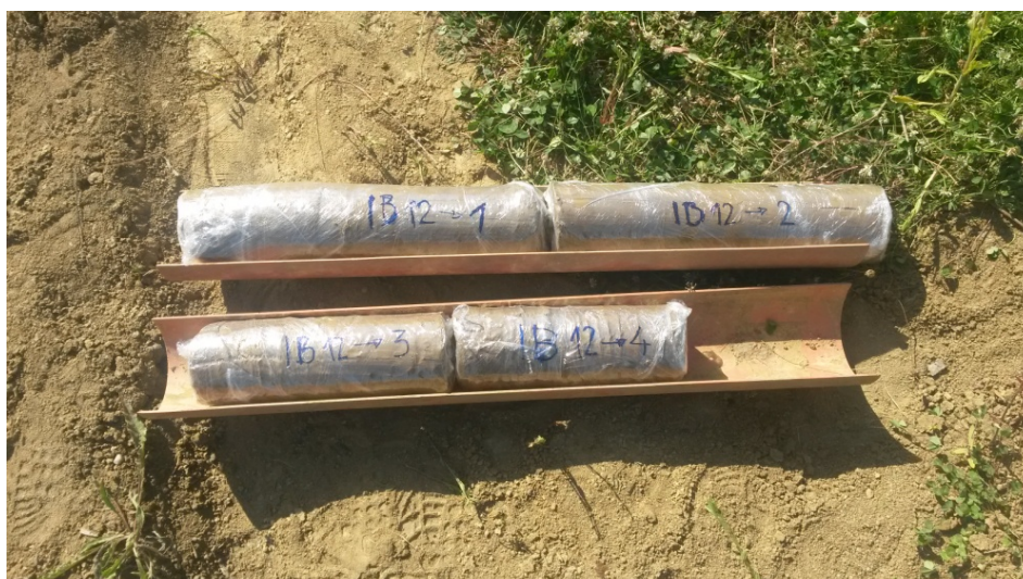
Slika 7.22 Izvađena jezgra na određenoj dubini
