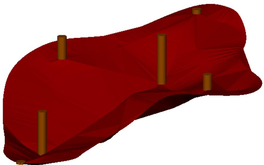
**Slika 5-2.** Slika podine rudnog tijela boksita s bušotinama
