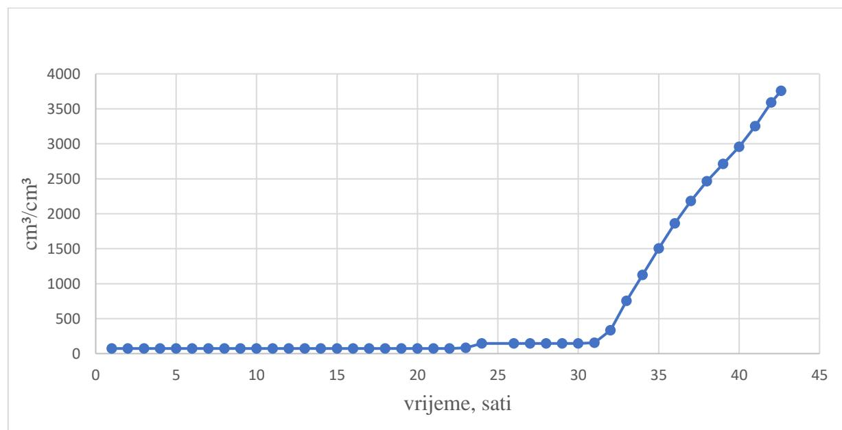
Slika 5-4. Omjer plina i nafte u uskoj cijevi
