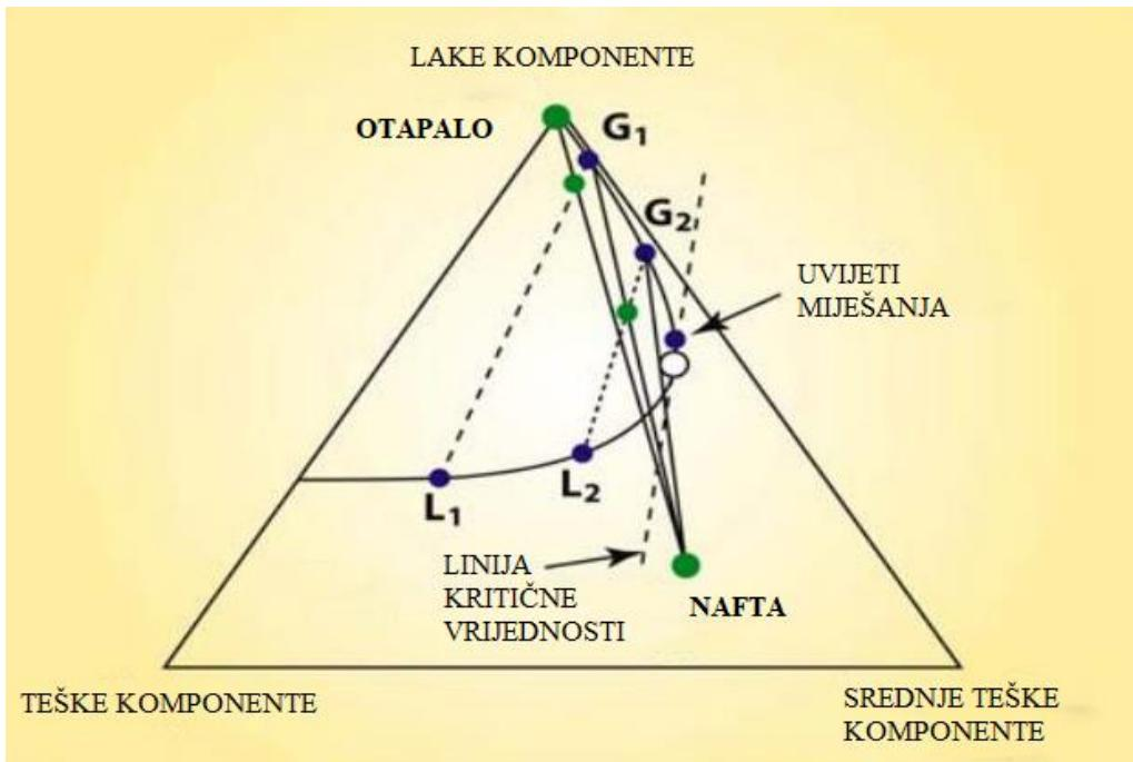
Slika 3-2. Multikontaktno istiskivanje suhim plinom (Lake, 1989)
