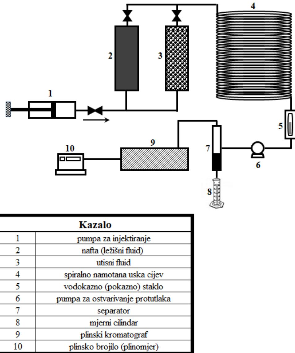
Slika 2-1. Aparatura testa uskom cijevi (Kantzias et al., 2018)
