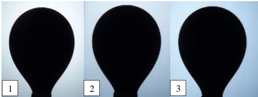
Slika 5-12. Usporedba fotografija kapljica nafte pri različitim koncentracijama surfaktanta: 1) 10%; 2) 20% i 3) 40%
