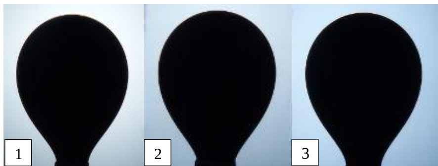
Slika 5-12. Usporedba fotografija kapljica nafte pri različitim koncentracijama surfaktanta: 1) 10%; 2) 20% i 3) 40%
