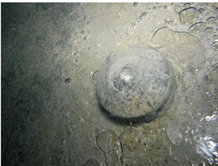
Slika 6-6. Mlaznice prije čišćenja (Crosco, 2012)
