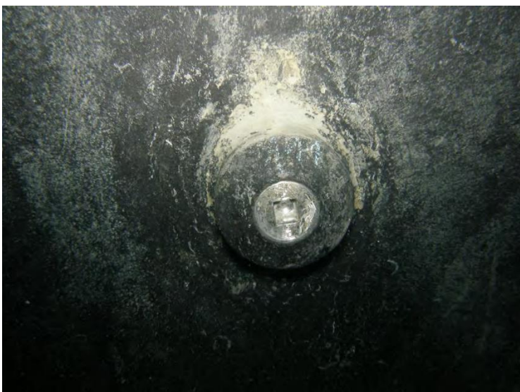
Slika 6-7. Mlaznice nakon čišćenja (Crosco, 2012)
