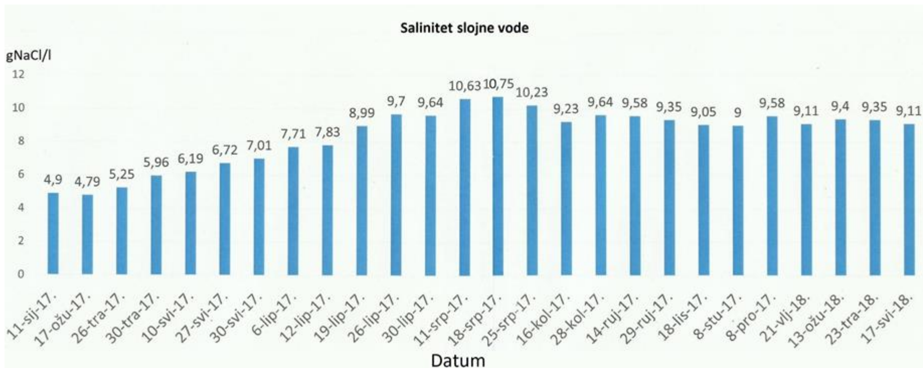
Slika 4-20. Trend kretanja saliniteta slojne vode pridobivene iz bušotine X-1 od siječnja 2017. do svibnja 2018. godine (Tehnička dokumentacija INA, d.d., 2018)
