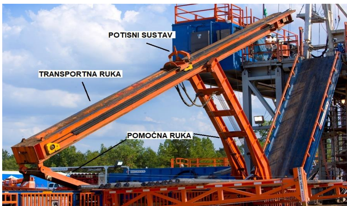
Slika 4-2. Automatizirani sustav za uvlačenje s podizanjem s dvije pomoćne ruke (Fet, 2018)
