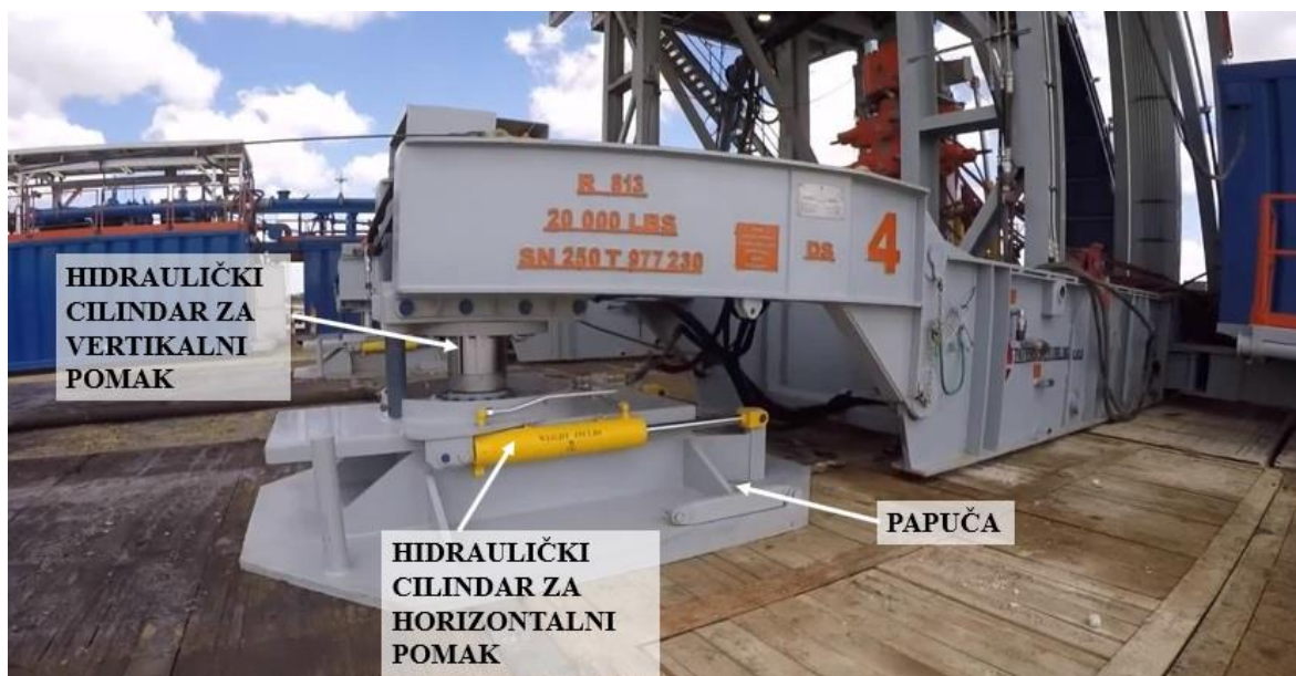
Slika 4-11. Samohodni sustav za preseljenje bušačkog postrojenja na malu udaljenost tvrtke Patterson- UTI (Patterson-UTI, 2017)
