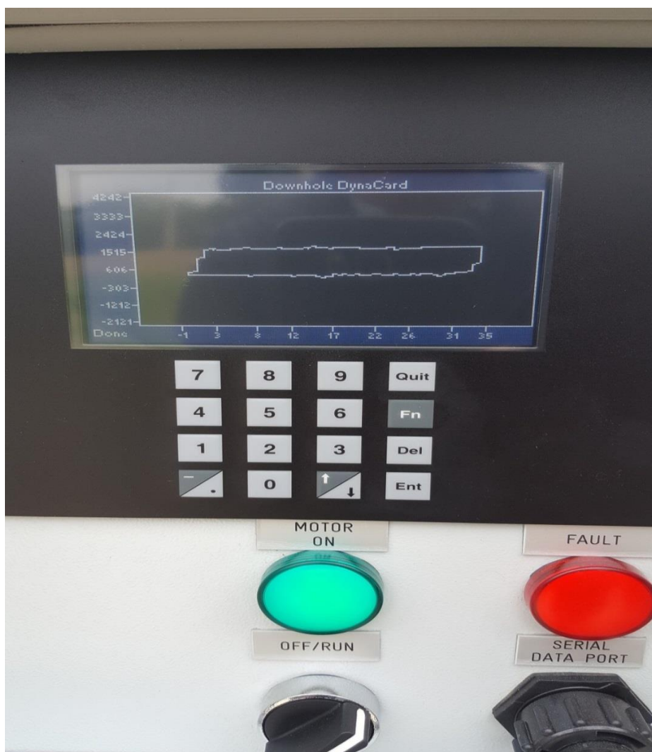
Slika 6-2. Prikaz dinamograma na nadzorno – upravljačkom regulatoru
