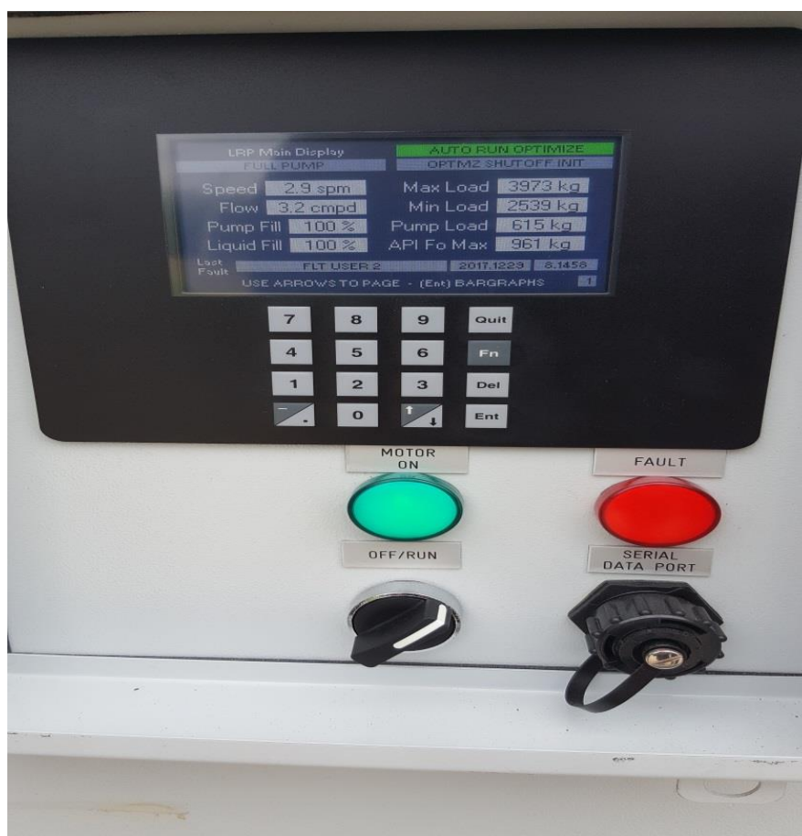
Slika 6-1. Kontroler s LCD prikazom i tipkama
