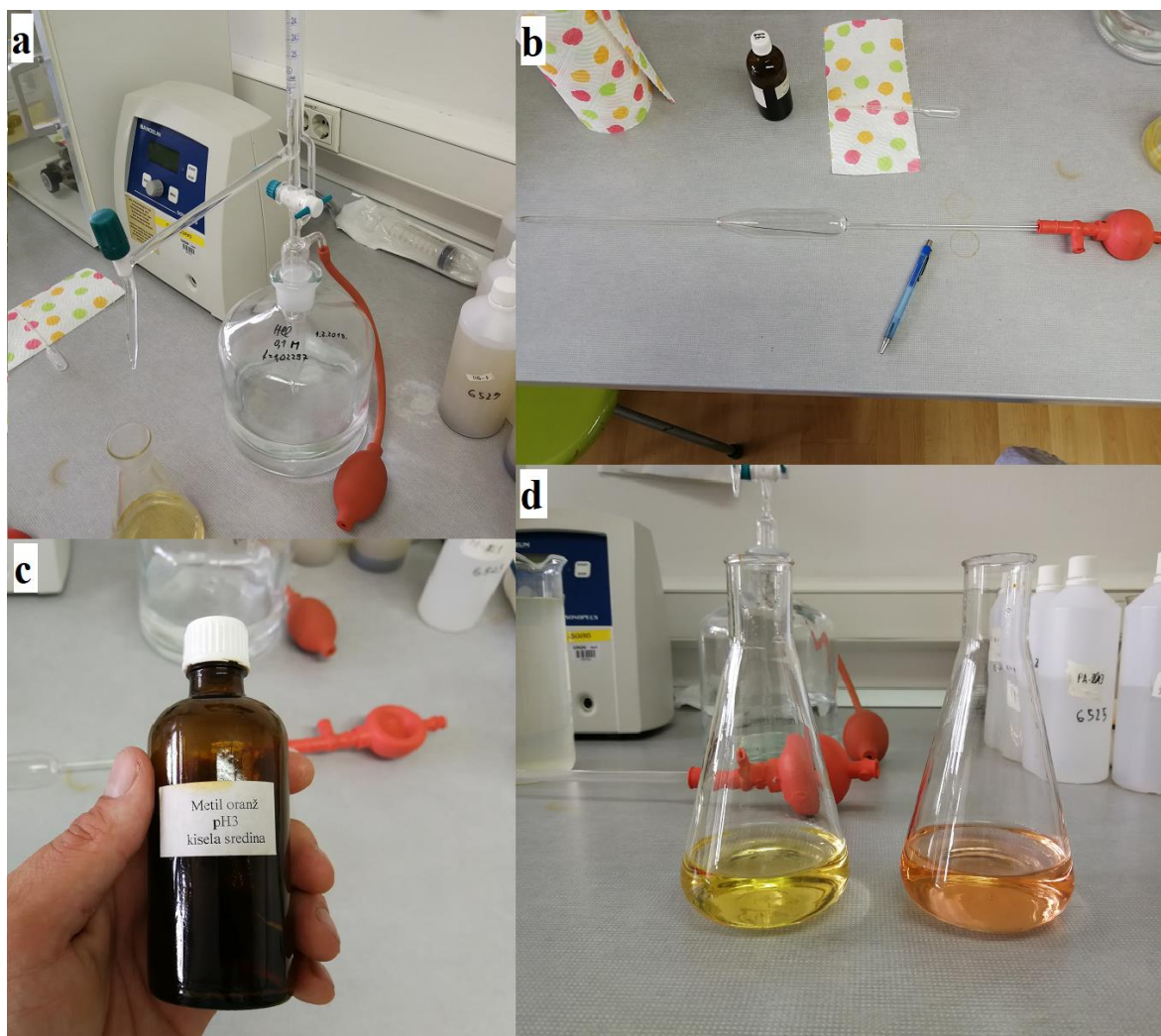
Slika 5.2. Titracija: (a) Otopina klorovodične kiseline i bireta; (b) Kapaljka i pipeta; (c) Indikator metiloranž; (d) Promjena boje otopine nakon titracije
