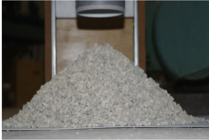
Slika 5-2. Formirana hrpa materijala nakon podizanja cilindra (Gaura, 2018)
