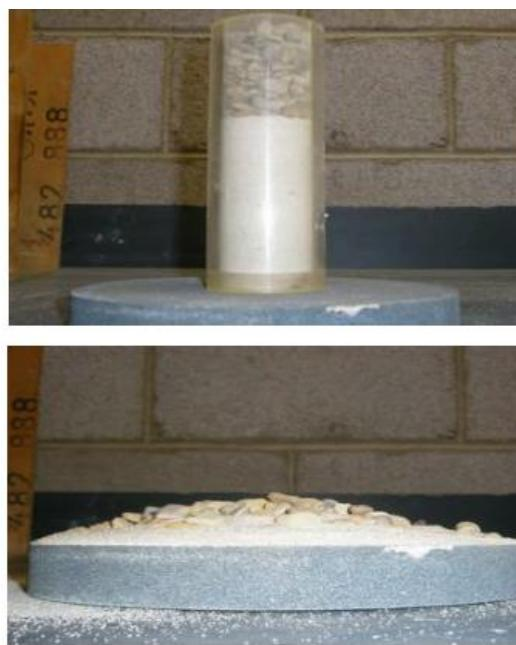
**Slika 2-4.** Cilindar prije i poslije podizanja sa slojem pijeska 10,0 cm, mala brzina podizanja, hrapava podloga (Liu, 2011)
