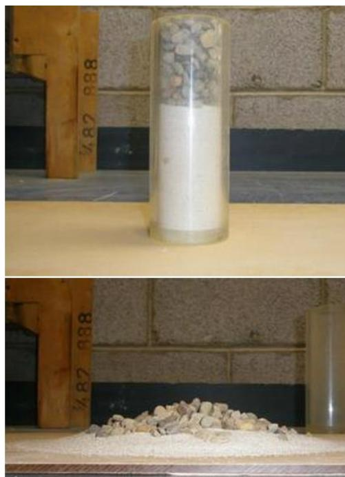
**Slika 2-3.** Cilindar prije i poslije podizanja sa slojem pijeska 10,0 cm, mala brzina podizanja, glatka podloga (Liu, 2011)
