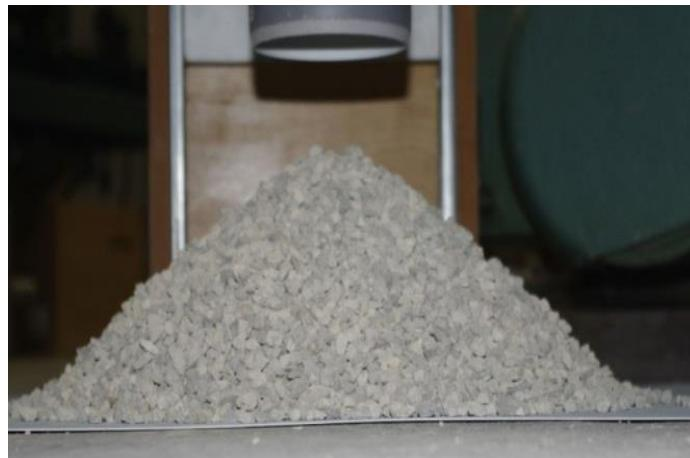
**Slika 5-2.** Formirana hrpa materijala nakon podizanja cilindra (Gaura, 2018)
