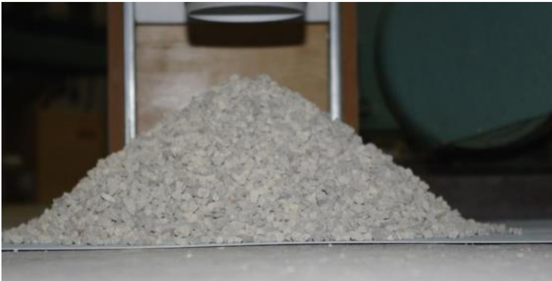
Slika 5-2 Mjerenje kuta sipanja na uzorku dolomitnog agregata
