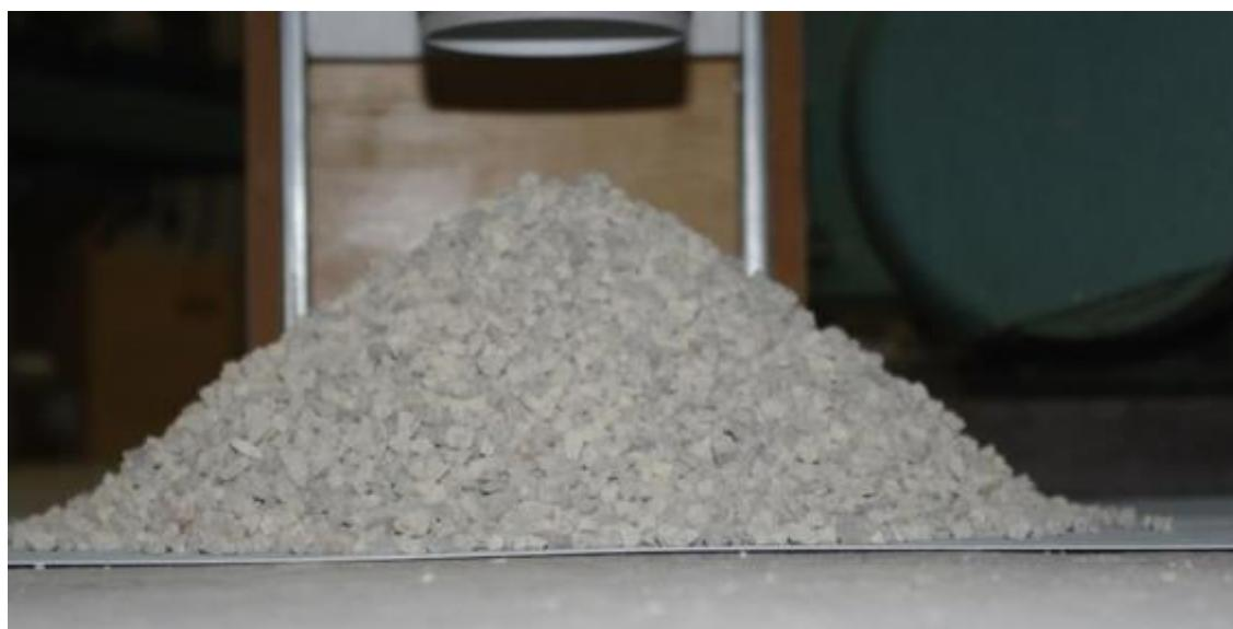
Slika 5-2 Mjerenje kuta sipanja na uzorku dolomitnog agregata
