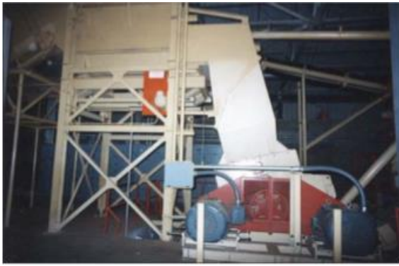
a) mehanička obrada – usitnjivač
