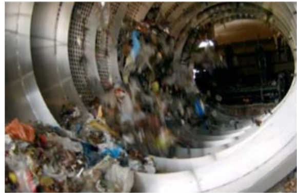
b) mehanička obrada – sito
