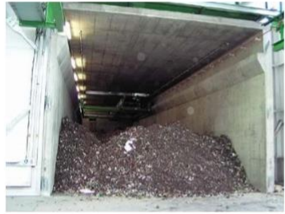
d) biološka obrada – sušenje
