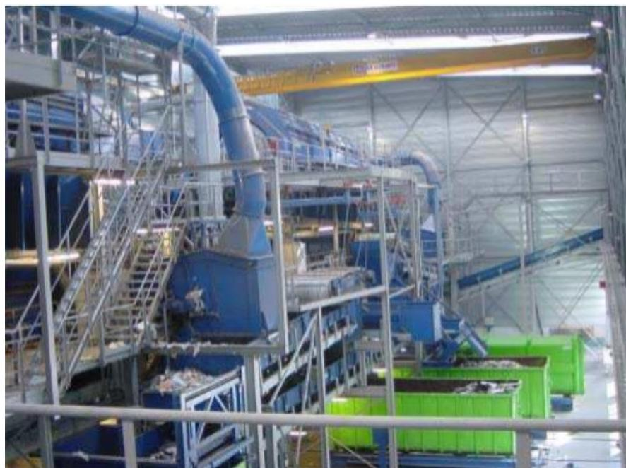
Slika 4-10: Dio postrojenja za mehaničku obradu otpada (Bekavac, 2010.)
