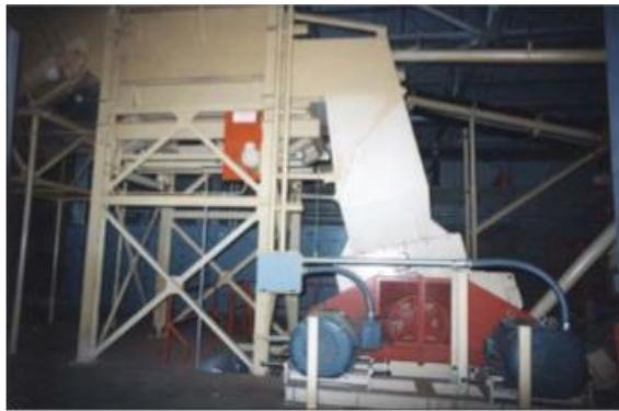
a) mehanička obrada – usitnjivač
