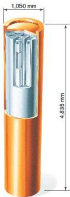
Slika 3—13 Prikaz bakrenog spremnika dizajniranog od strane Švedskog SKB (SKB, 2010.)
