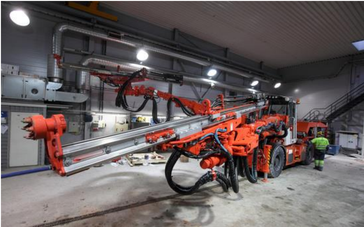
Slika 3—15 Bušeci stroj korišten u Onkalu (Posiva, 2019).
