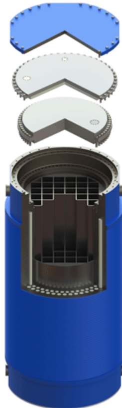
Slika 2—3 Metalni spremnik tipa Castor Geo razvijen od strane Njemačke firme GNS (GNS, 2019).
