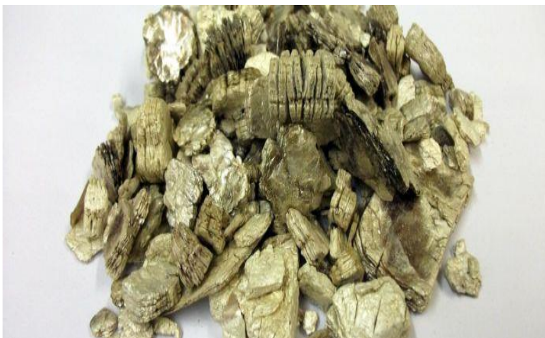
Slika 3-2 Zrnca vermikulita (Veliki rečnik, 2016)
