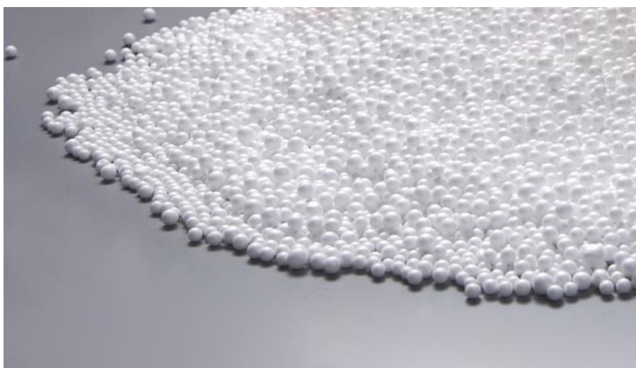
Slika 3-6 Zrnca ekspanziranog polistirena (Polistireninio putplasćio asociacija, 2017)
