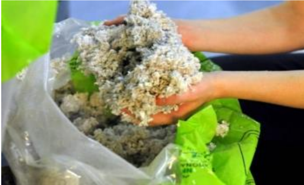
Slika 3-11 Granule celuloze (Arhiteko d.o.o, 2018)
