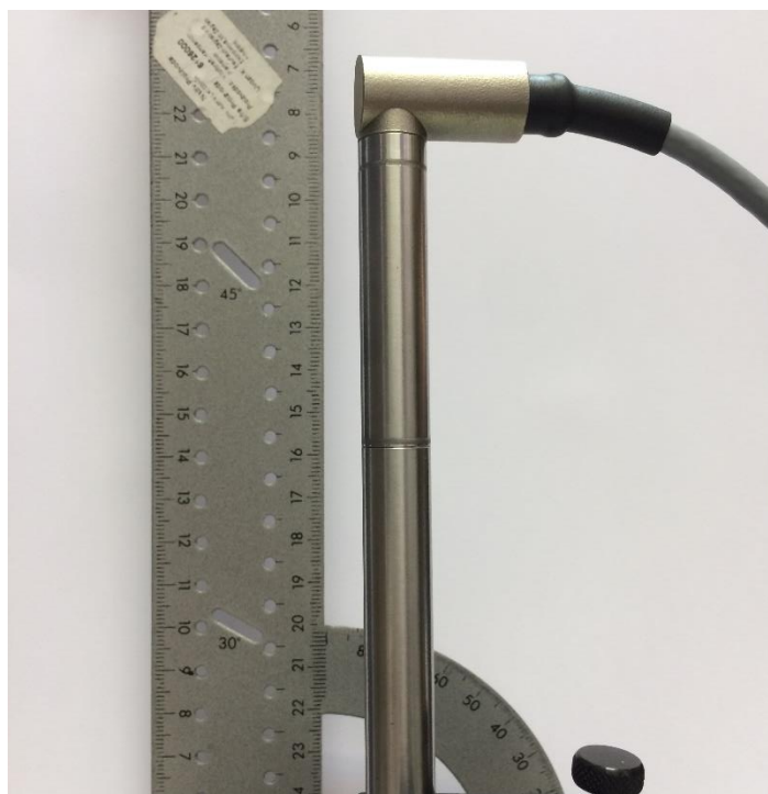
Slika 3-8 Okomitost pretvornika pomaka HBM WA10
