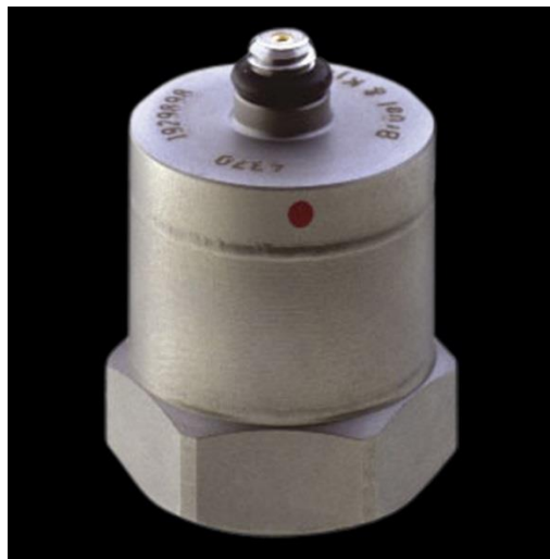
Slika 3-2 Referentni akcelerator B&K 4370 (Brüel & Kjær, 2004)
