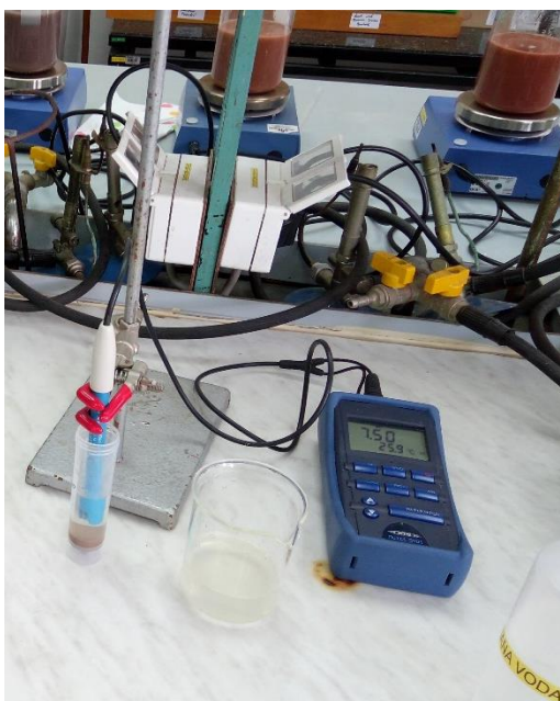
Slika 3.5. Mjerenje pH pomoću pH-metra WTW Multi 340i (foto: Tomislav Pavelić, 2018.)
