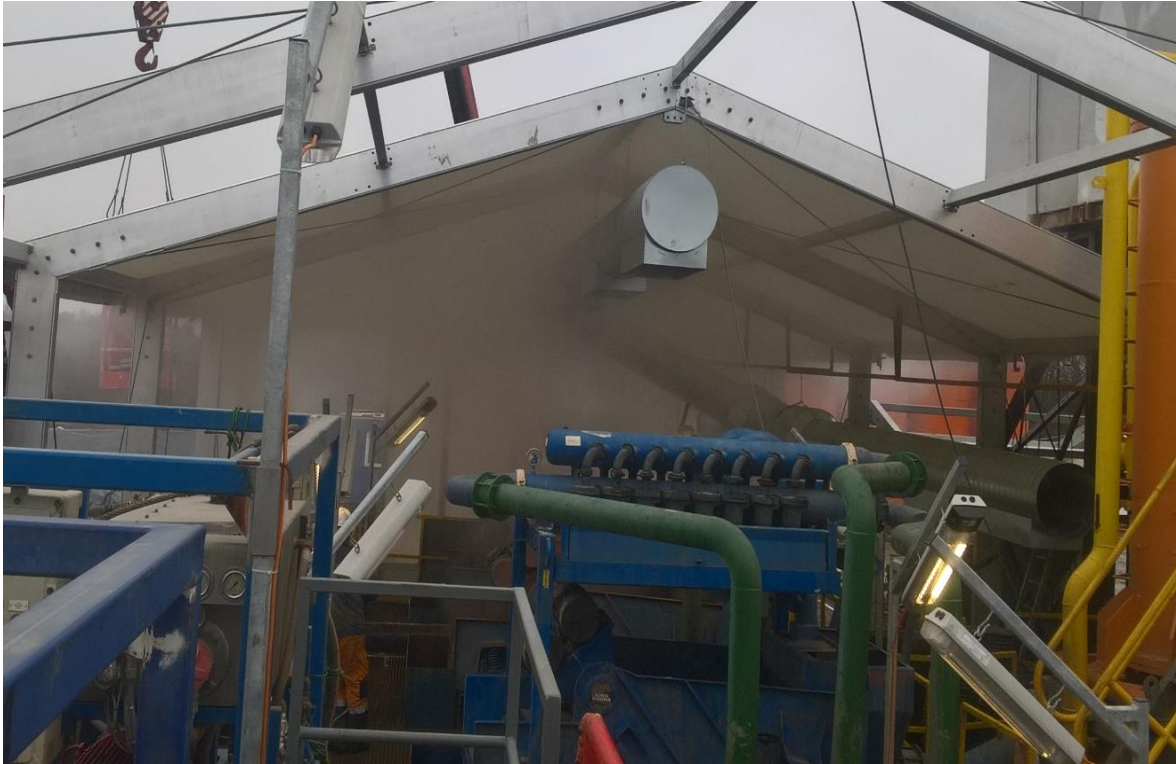
Slika 3-13. Isparavanje isplake unutar šatora s vibratorima i bazenima za pročišćavanje isplake (Crosco, 2017b)
