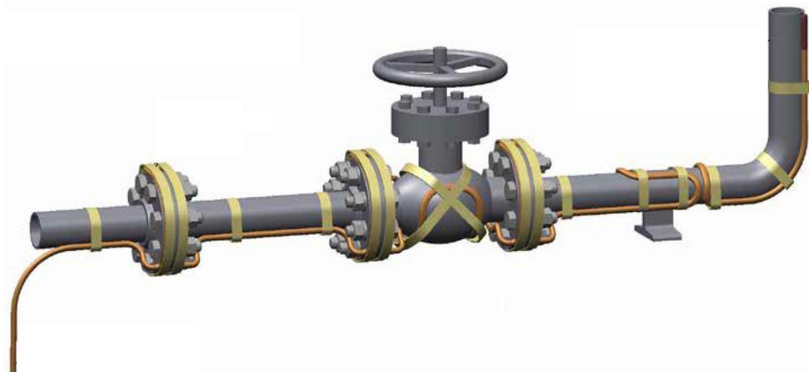
Slika 3-14. Prikaz postavljenog grijaćeg kabela na cjevovodu (Thermon, 2018a)
