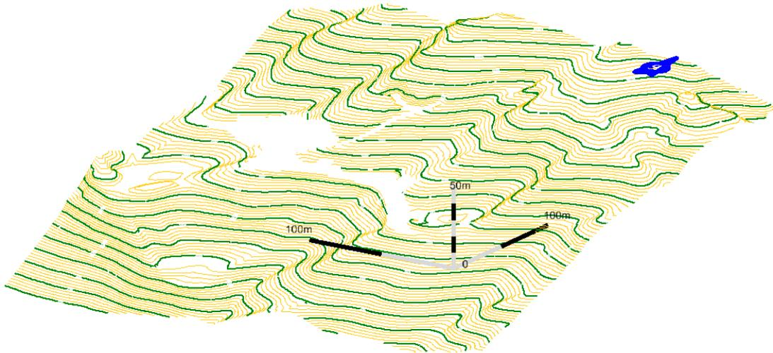
Slika 6.3 Slojnice istražnog područja „San“ prikazane u 3D modelu
