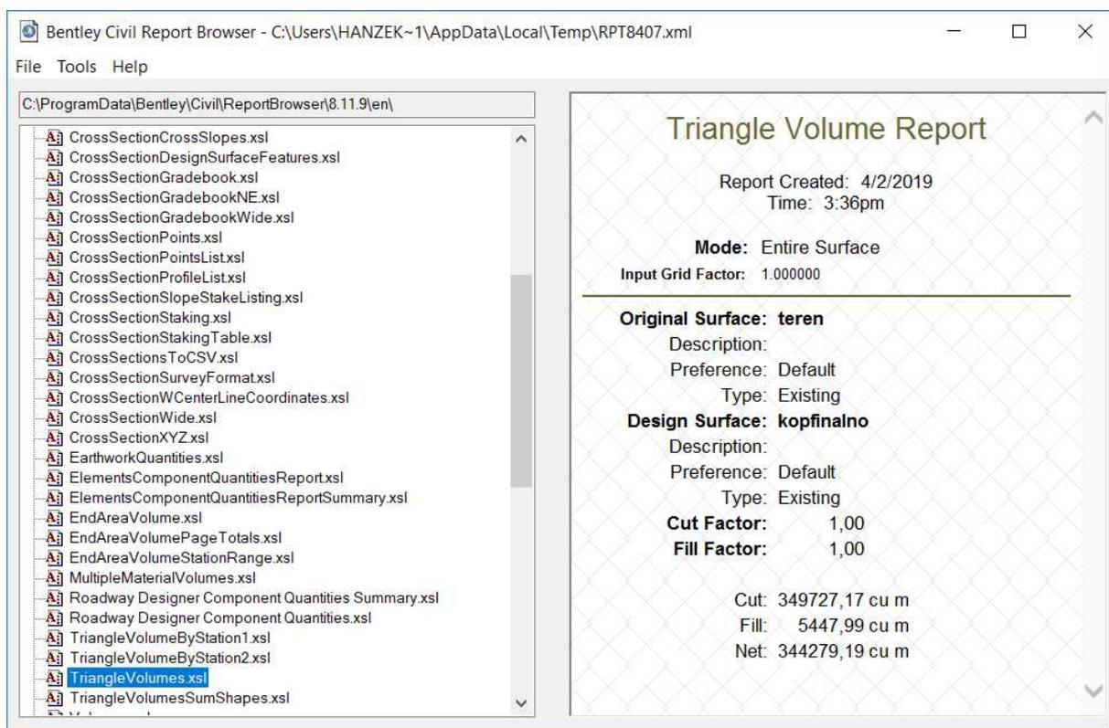
U rezultatima izračuna, *Cut* predstavlja obujam otkopanog materijala, *Fill* obujam nasipnog materijala, a *Net* je razlika. Vrijednosti su izražene u kubičnim metrima.
