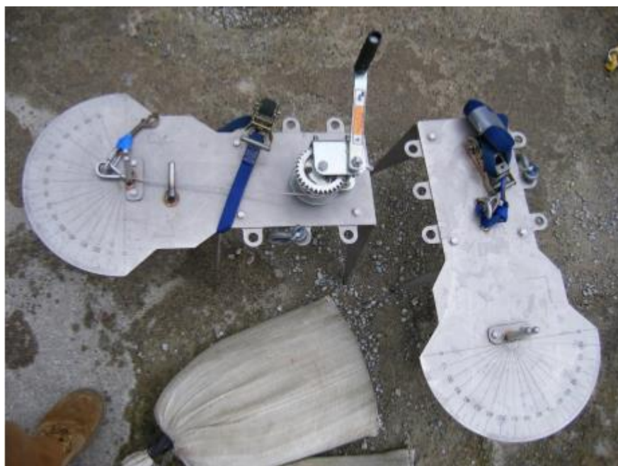
Slika 6-4. Ploče s kutomjerima za podvodna mjerenja zategnutom žicom (Abel, 2014)
